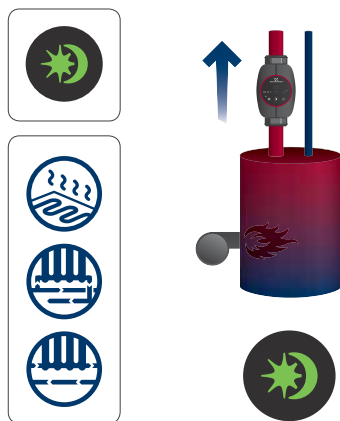
Obr. 22 Automatická nočná redukovaná prevádzka aktivovaná s rozsvieteným zeleným svetelným políčkom.
